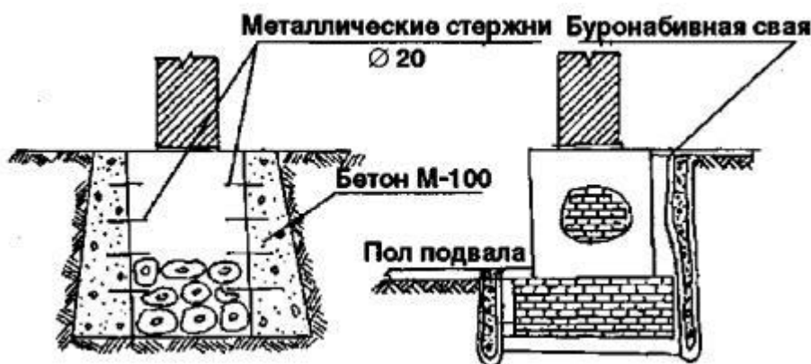
Рис. 3. Уширение подошвы фундамента
