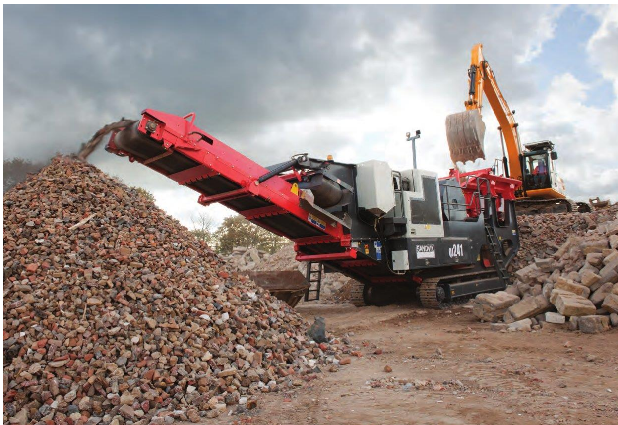
Рис. 4.1.11. Мобильные установки для переработки вторичного железобетона и строительных отходов фирмы PARKER
