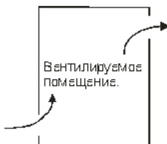
Рис. 6.1.5. Приточно-вытяжная система бесканальной вентиляции с (гравитационным, под действием ветра) естественным побуждением (аэрация)
