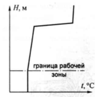
Рис. 3.2. Распределение температуры воздуха по высоте помещения с естественным расслоением воздуха в виде «температурного перекрытия» или «тепловой подушки»
