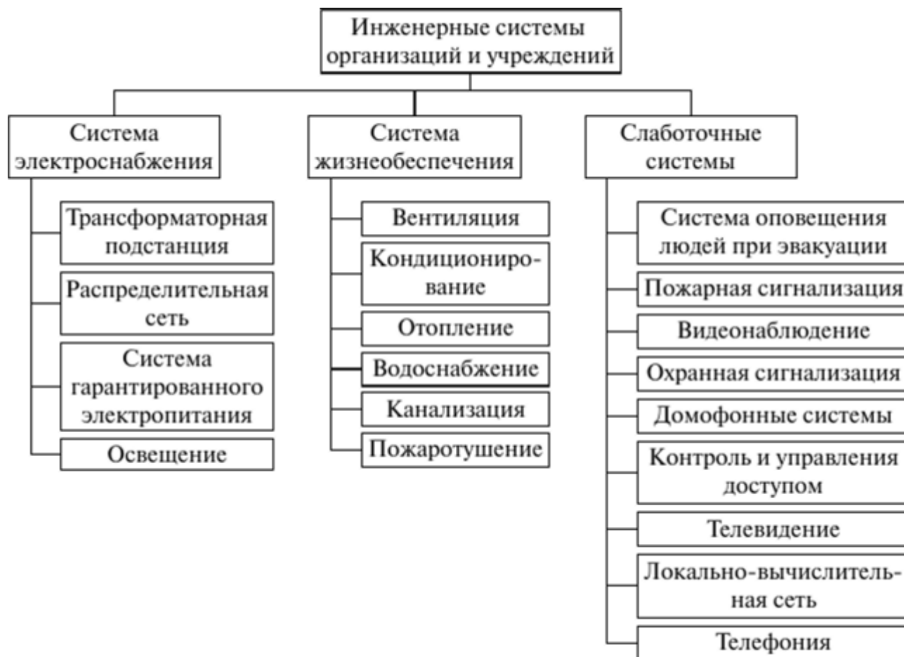
Рисунок 1.1. Классификация инженерных систем
