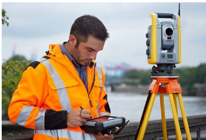
Рисунок 5.1. Электронный тахеометр Trimble S6
