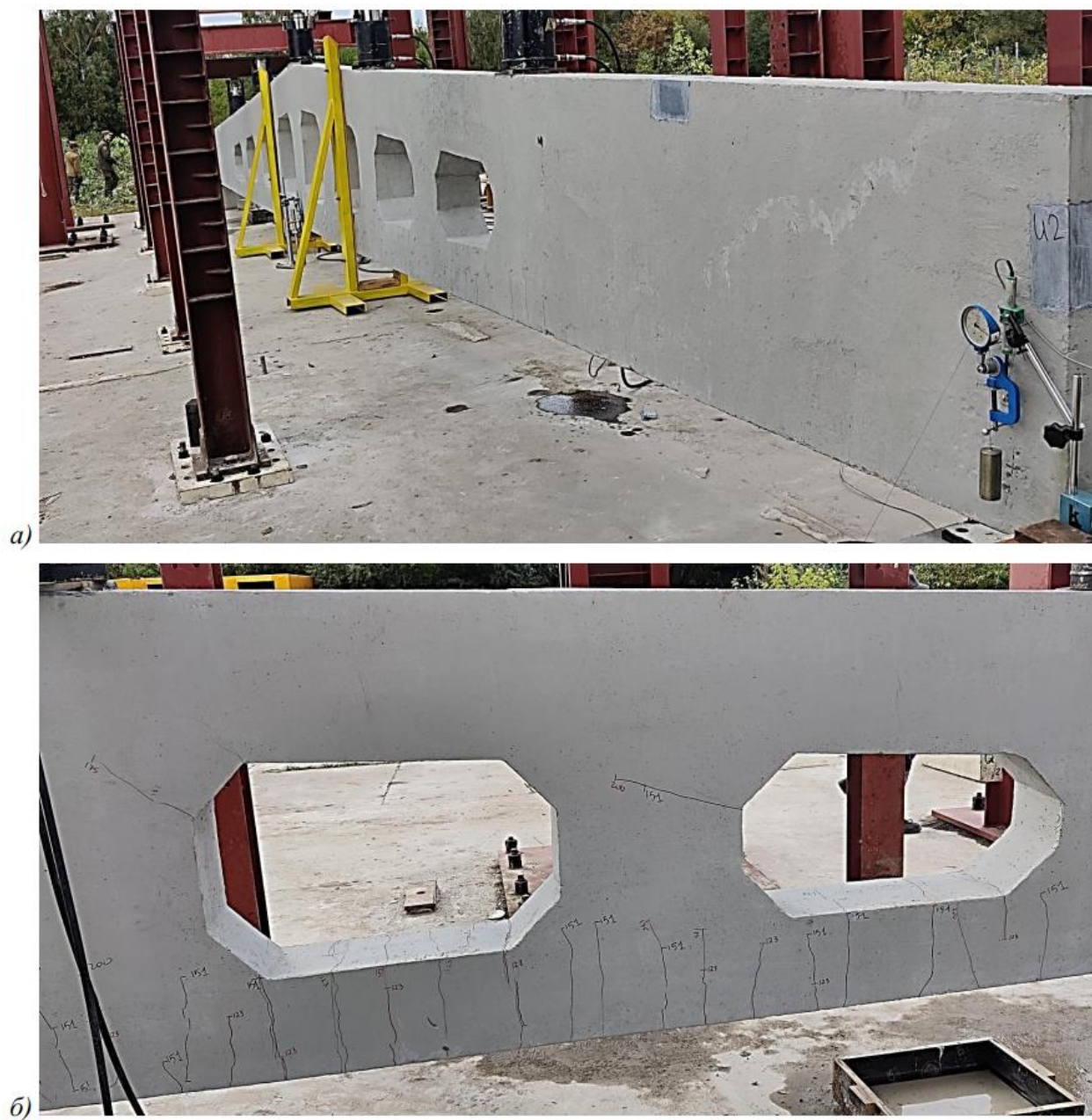
Рисунок 12.1. Состояние Образца №1 на момент окончания испытания P_{test.1} = 200.8 кН а) общий вид образца; б) трещинообразование в нижнем поясе
