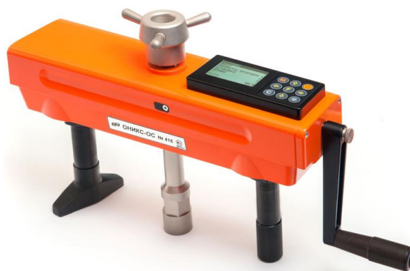
Рисунок 2.1. Общий вид прибора «Оникс-ОС»
