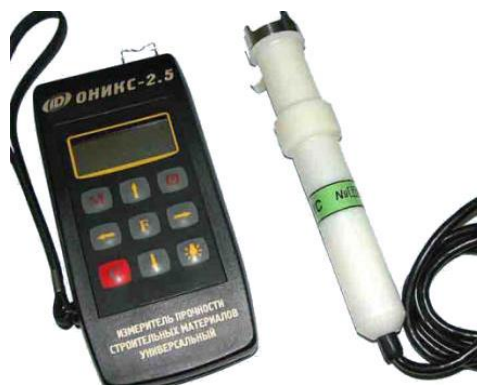
Рисунок 2.2. Общий вид прибора «Оникс-2.5»
