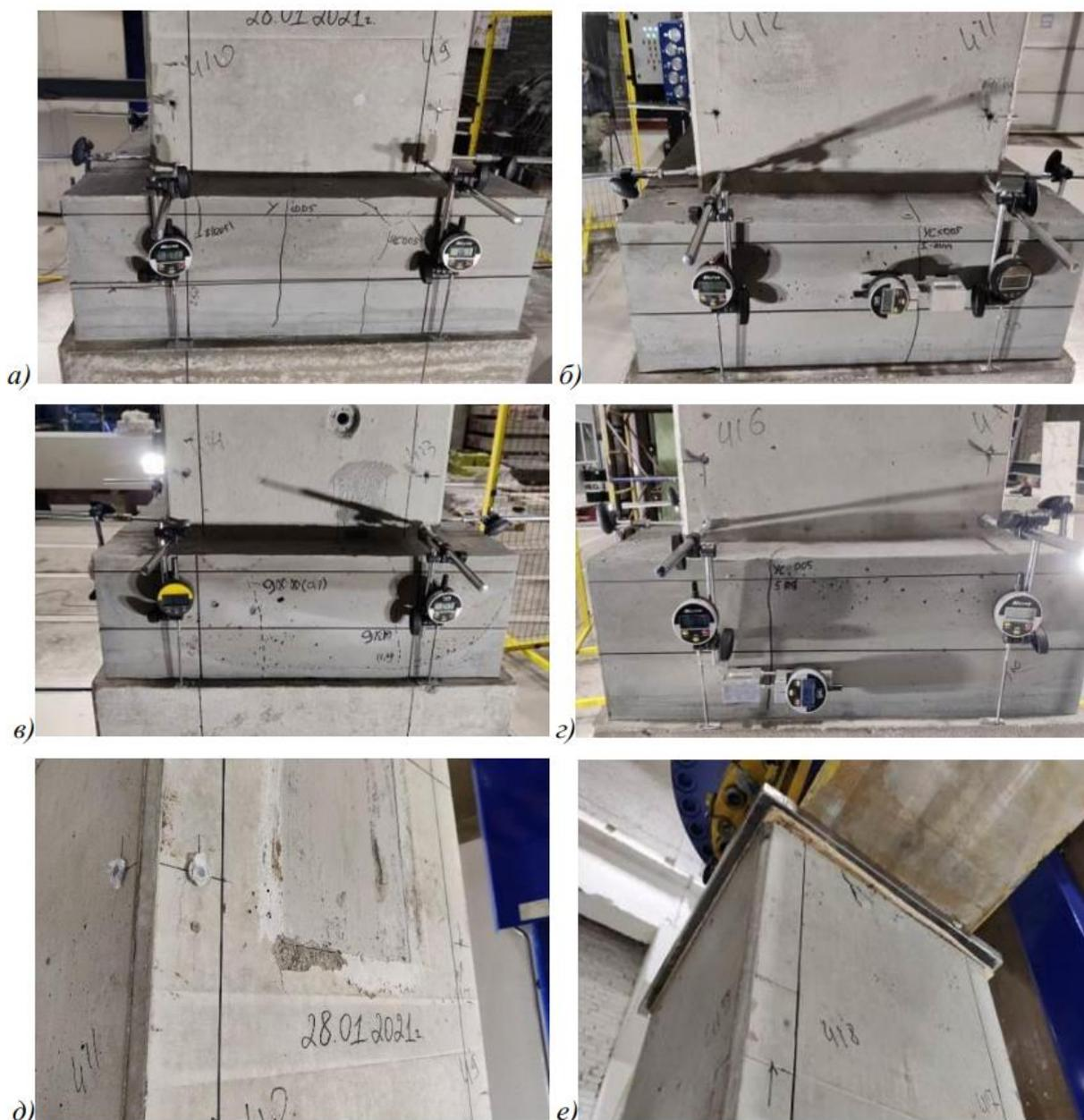
Рисунок 7.2 – Параметры трещинообразования в стыке
