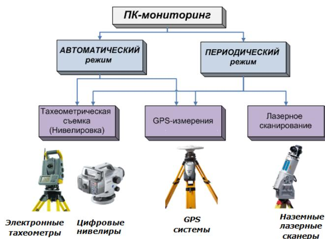
Рисунок 4.1 - Методы и средства геодезического мониторинга пространственно-координатного положения сооружения
