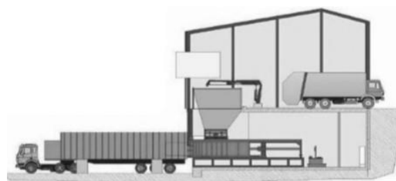
Рис. 2.11. Перегрузка из малотоннажных мусоровозов с задней загрузкой в большегрузные мусоровозы на мусороперегрузочной станции с использованием прессующего устройства
