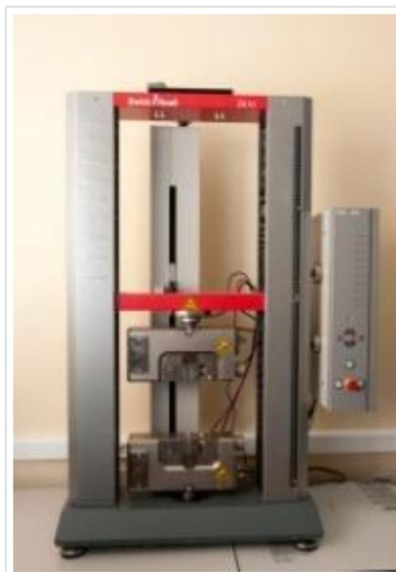
Рис. 6.10. Испытательная машина Zwick Z010 серии Proline
