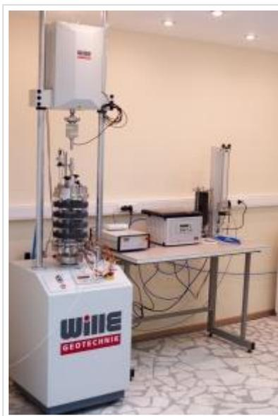
Рис. 6.9. Установка для проведения испытаний в условиях трехосного сжатия Wille LO7060/SP05 (частотой до 5 Гц)
