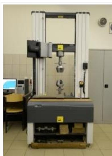
Рис. 6.7. Универсальная электромеханическая машина Instron 3382
