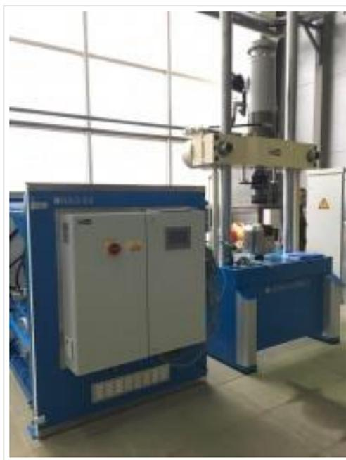
Рис. 6.1. Универсальная динамическая испытательная машина LabTest 6.500H.5.01.1
