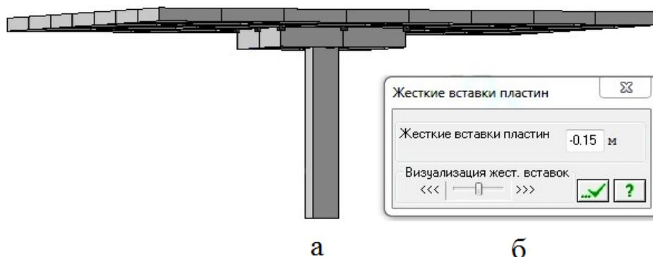
Рис. 2.27. Фрагмент расчетной схемы (а) и диалоговое окно команды *жесткие вставки пластин* (б) при моделировании монолитного безбалочного перекрытия с капителями
