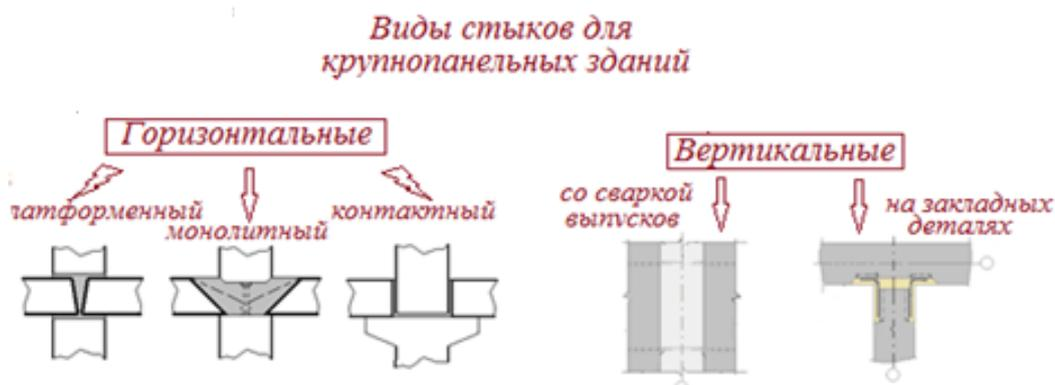
Рис.4.36. Классификация стыков крупнопанельных зданий
