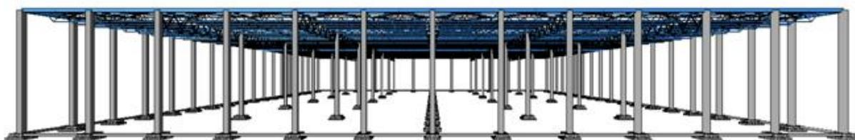
Рис.4.25. Пространственная расчетная модель одноэтажного производственного здания
