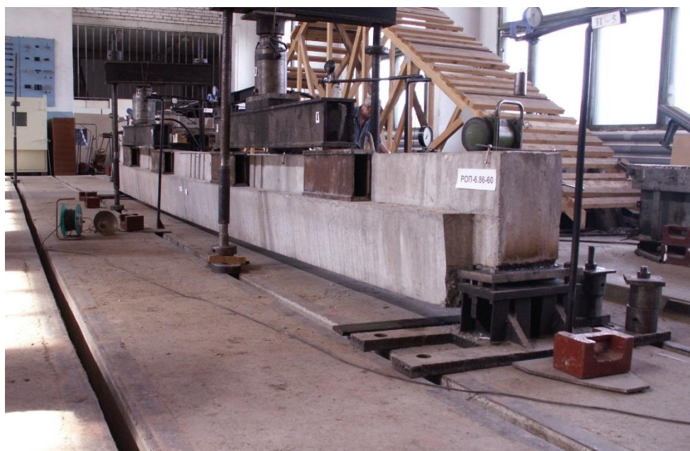
Рис. П.2.3. На восьмом этапе нагружения при суммарной нагрузке на ригель P_8 = 491,4 кН величина изгибающего момента составила M_7 = 519,1641 кН*м (что составляет 101,88% момента от контрольной нагрузки по проверке жесткости конструкции). Прогиб ригеля при этом – 24,6261 мм. Данная величина прогиба превысила величину контрольного прогиба f_k = 23,1 мм. Ширина раскрытия трещин составляла 0,05...0,1 мм.
