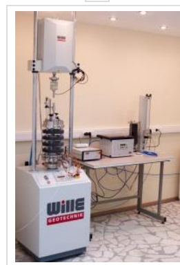
Рис.6.2. Экспериментальное оборудование лаборатории испытания строительных конструкций: а –контроллер давления CPC6050, б –испытательная установка для моделирования сейсмического воздействия на анкерные соединения, в –установка истинного трехосного сжатия (комплект Геотек ГТ 0.3.20), г –установка для проведения испытаний в условиях трехосного сжатия Wille LO7060/SP05 (частотой до 5 Гц)
