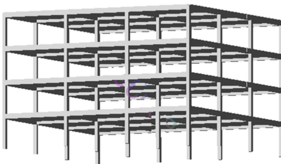
Рисунок 2.22. Фрагмент пространственной модели (3D-графика) объемной расчетной модели многоэтажного здания колонной конструктивной системы с балочным перекрытием
