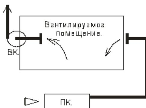
Рис. 6.1.1 Прямоточная приточно-вытяжная система вентиляции с механическим побуждением
