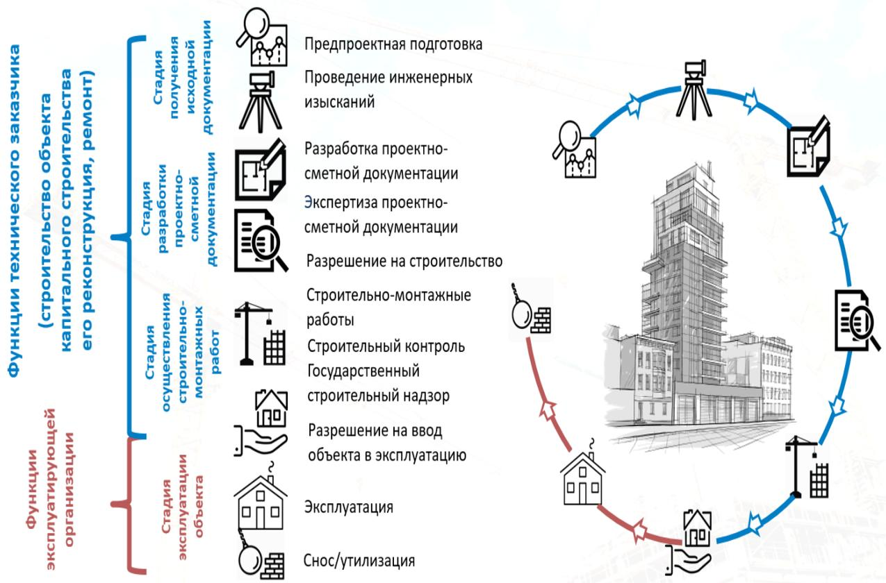
Рисунок 3.9. Схема жизненного цикла объекта капитального строительства.
