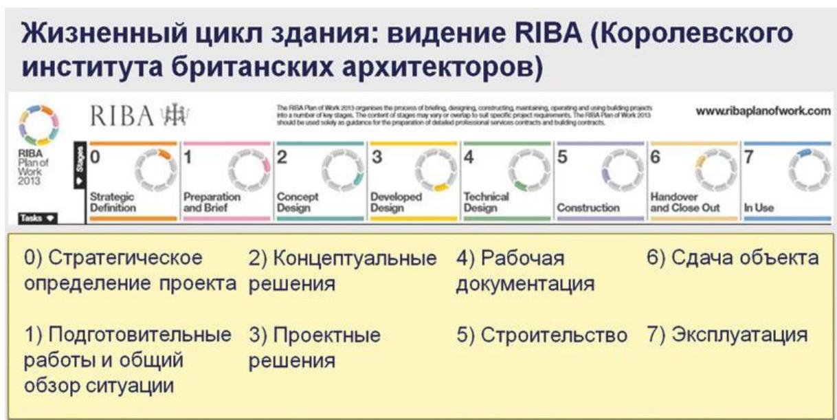
*Рис. 2. Восемь этапов жизненного цикла здания как разделы «Рабочего плана» RIBA*
