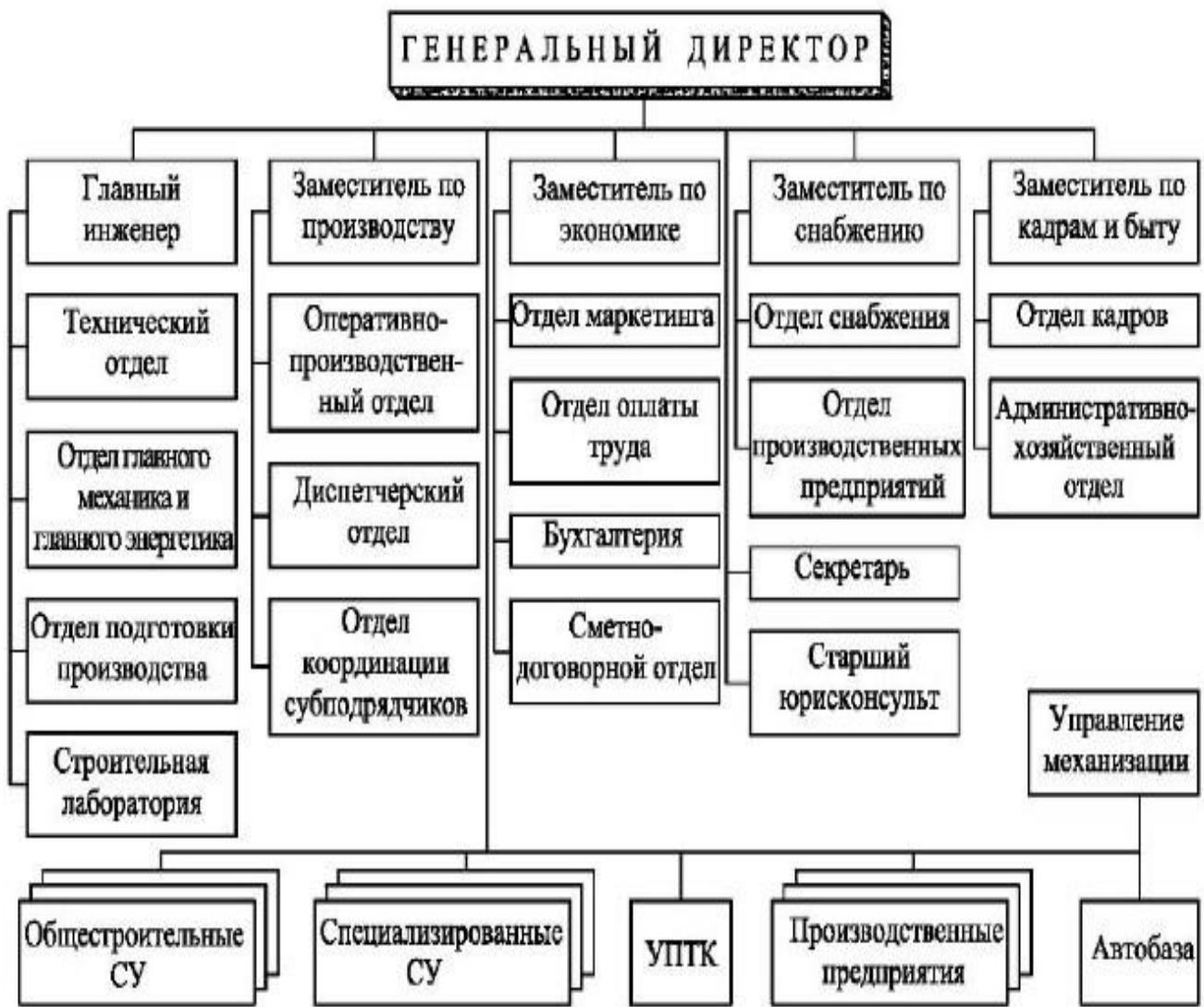
Рисунок 3.2. Структура управления крупным строительным предприятием.
