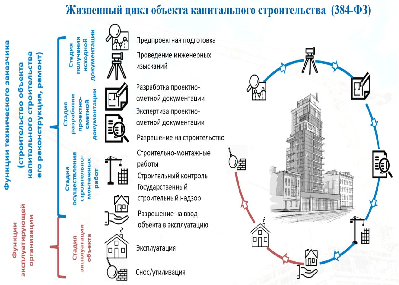
Рисунок 3.9. Схема жизненного цикла объекта капитального строительства.
