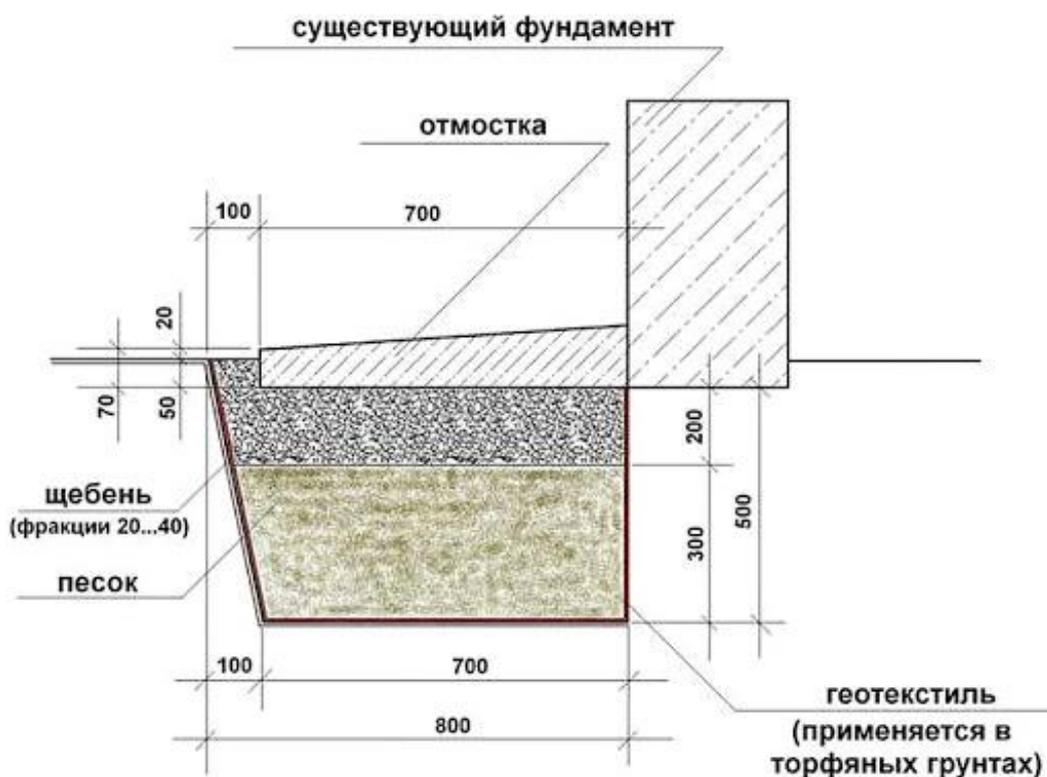
Рис. 37. Устройство отмостки
