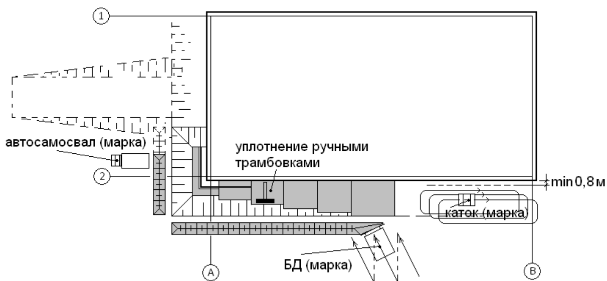
Рисунок 27. Схема обратной засыпки пазух котлована.
