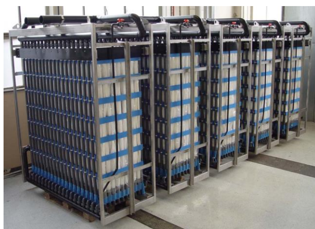
Рис. 3.17. Устройство погружного ультрафильтрационного модуля.
