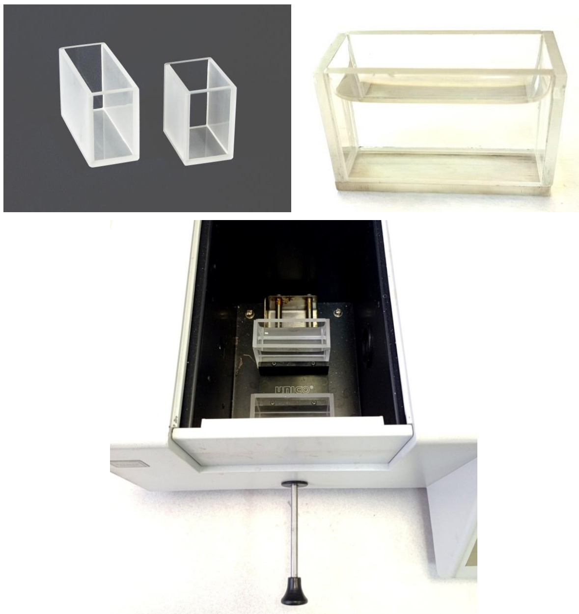
Рис. 1.8. Кварцевые кюветы и кюветное отделение спектрофотометра.
