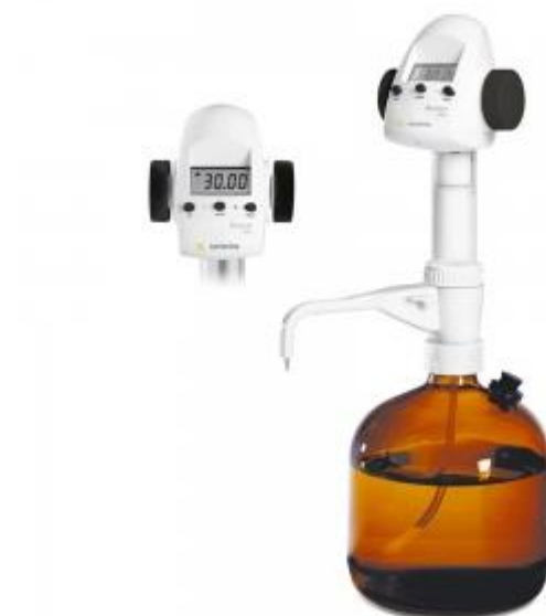
Рис. 1.5. Автоматическая (цифровая) бюретка.
