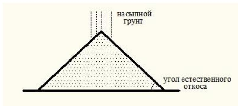
Рис. 2.9. Элементы уступа несвязного грунта
