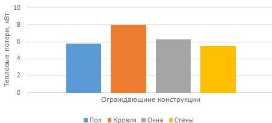
Рис.1.1. Теплопотери через ограждающие конструкции
