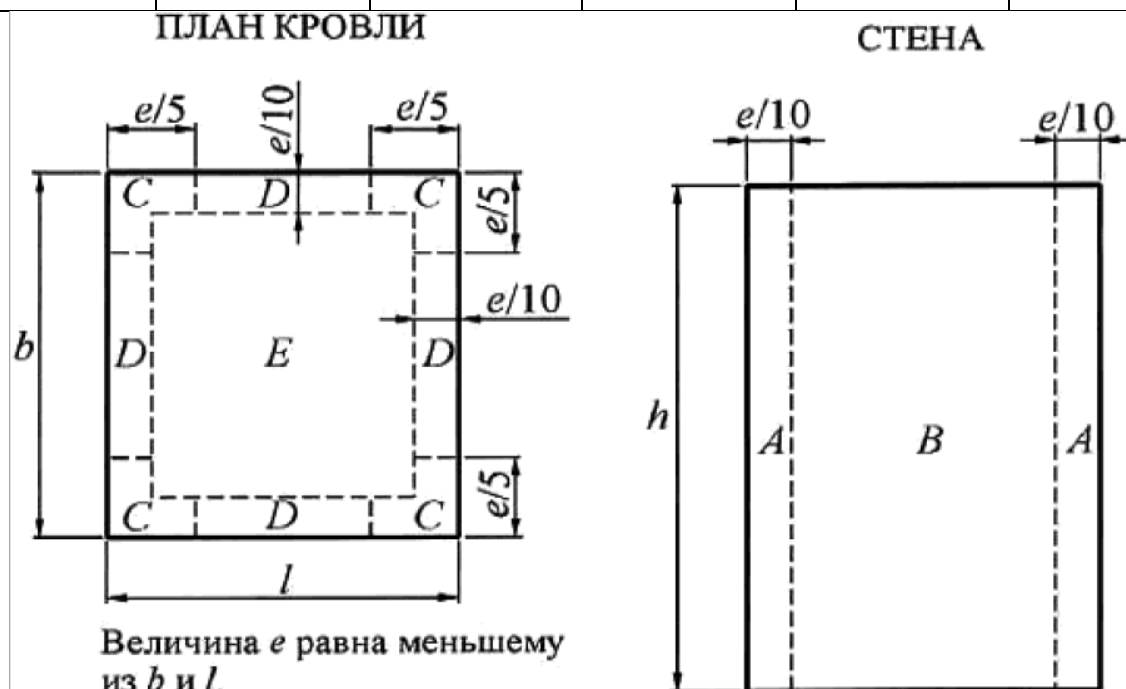
Рис. 5.1. Зоны плоских перекрытий и стен
