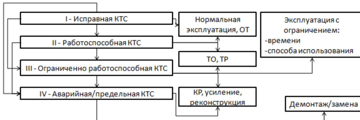
Рисунок 1. Алгоритм возможных действий после оценки категории технического состояния (КТС): ОТ - осмотры технические, ТО - техническое обслуживание, ТР - текущий ремонт, КР - капитальный ремонт
