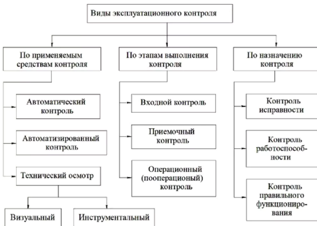
Рисунок 1.13. Виды эксплуатационного контроля
