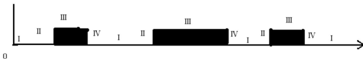
Рисунок 2.6. Диаграмма состояний системы: I — состояние исправное; II — переход в неисправное состояние (отказ); III — состояние отказа; IV — переход в исправное состояние
