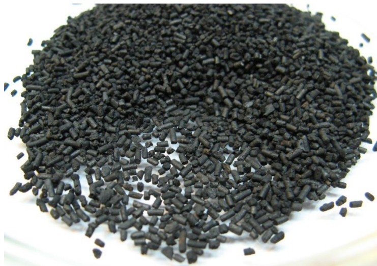
Рис. 4.52. Внешний вид активного угля АГ-3
