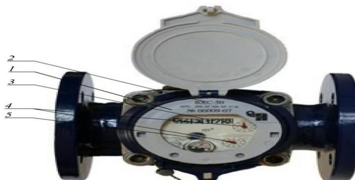
Рисунок 48. Общий вид скоростного (турбинного) счетчика 1-номер счетчика, 2-марка счетчика, 3-показания счетчика в м<sup>3</sup>, 4-стрелки показывающие расход воды в 10 и 100 литров, 5-стрелка- показывающая расход в литрах.
