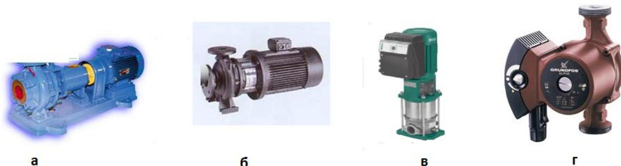
Рисунок 32. Типы насосов. а- консольные (тип К), б- консольно-моноблочные (тип КМ) , в,г- консольно-моноблично-линейные (in-line) (тип КМЛ)
