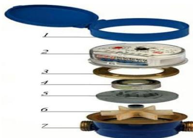
Рисунок 46. Общий вид крыльчатого счетчика воды 1-корпус верхний с крышкой, 2-счетчик, 3-гайка фиксатор, 4-магнитная муфта, 5-кольцо магнитной защиты, 6-крыльчатка, 7-корпус крыльчатки
