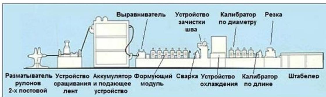
*Рис.3.17. Пример линии производства стальных электросварных труб*
