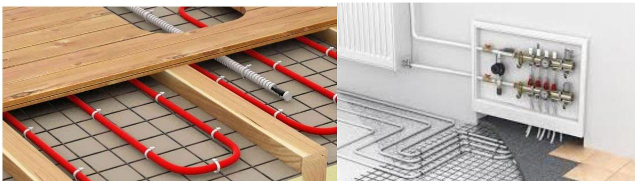
Рис. 2.24. Панель напольного отопления
