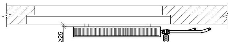
Рис. 2.34. Расстояния при установке радиатора системы отопления
