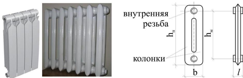
Рис.2.18. Секционный радиатор
