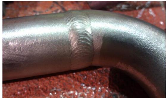
Рис.2.30. Соединение встык
