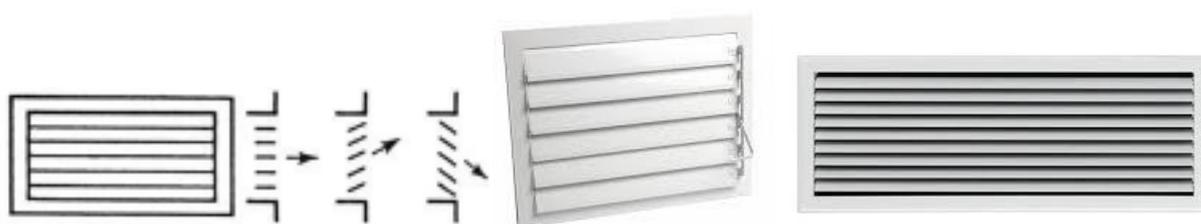
*Рис.3.37. Решётка с горизонтальными пластинами*
