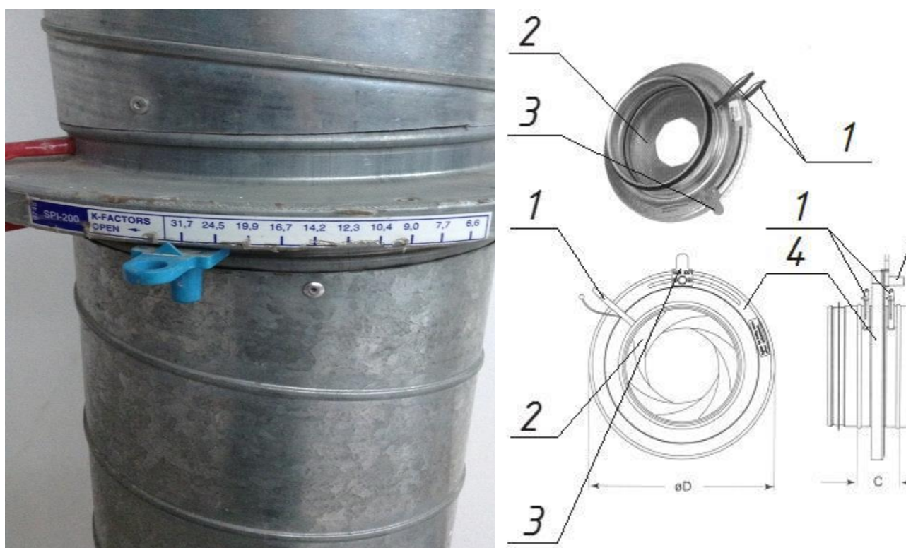
Рис. 3. Конструкция ирисовой диафрагмы: 1 – штуцеры отборников статического давления; 2 – «лепестки» ирисовой диафрагмы; 3 – рычаг, перемещением которого изменяется диаметр отверстия для прохода воздуха; 4 – корпус кольцевой формы
