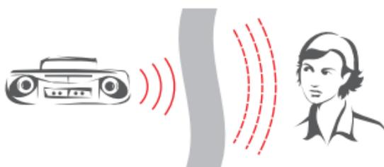
*Рис. 7.2.1 Механизм передачи воздушного шума*
