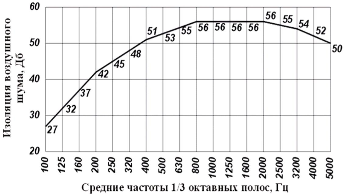
Рис. 7.3.1. Нормативная частотная характеристика изоляции воздушного шума ограждающей конструкции
