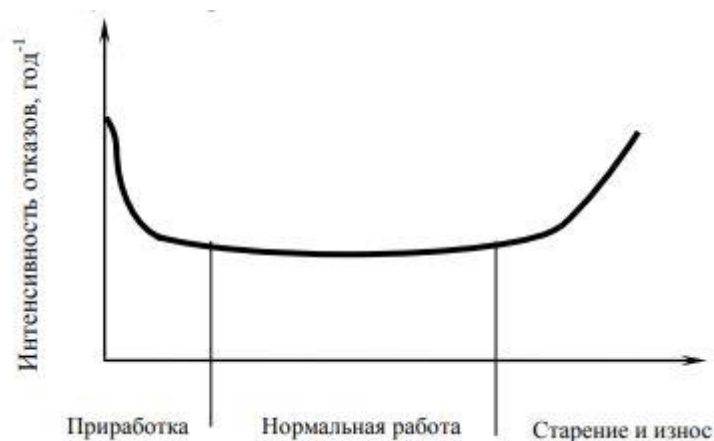
Рис. 1. Изменение интенсивности отказов в течение эксплуатационного периода
