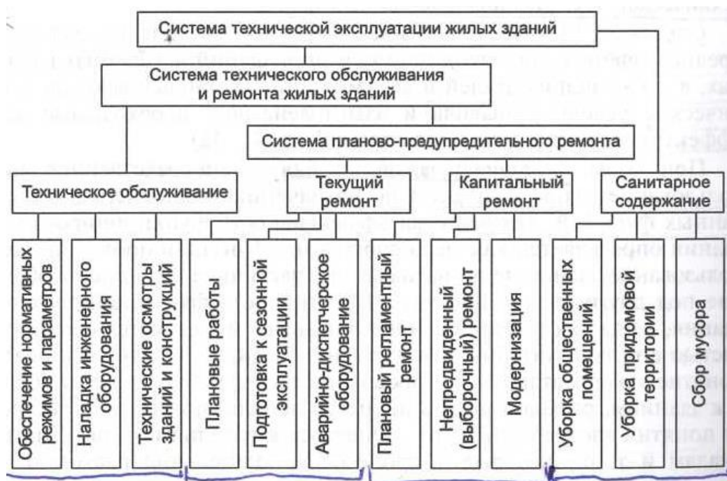
Рис. 2.1. Содержание и состав системы технической эксплуатации жилищного фонда
