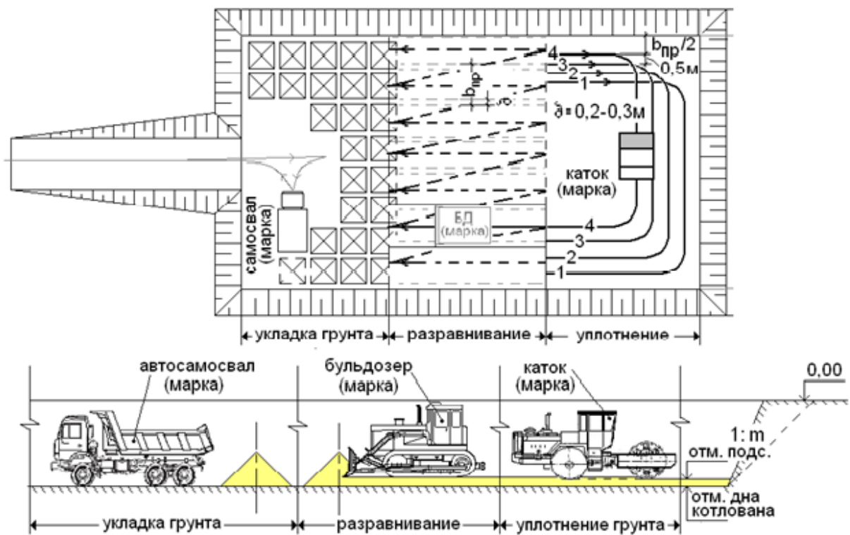
1.4. Устройство песчаной подсыпки на дне котлована
