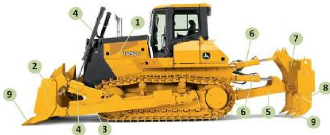
Рис. 2.13.1. Бульдозер-рыхлитель: 1 – базовый трактор; 2 – отвал; 3 – толкающие брусья с рамой; 4 – гидроцилиндры управления отвалом; 5 – рама рыхлителя; 6 – гидроцилиндры управления рыхлителем; 7 – рабочая балка; 8 – сменный зуб рыхлителя; 9 – сменные литые износостойкие накладки ножа отвала и наконечники зубов рыхлителя.
