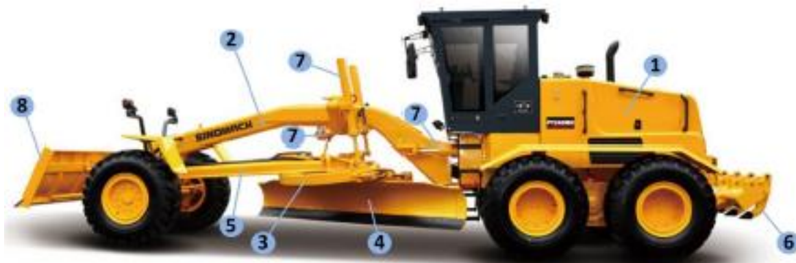
Рис. 2.13.4. Принципиальная схема автогрейдера: 1 – силовой агрегат; 2 – основная рама; 3 – поворотный круг; 4 – отвал; 5 – тяговая рама; 6 – рыхлитель (опционально); 7 – гидроприводы управления положением отвала; 8 – передний отвал.
