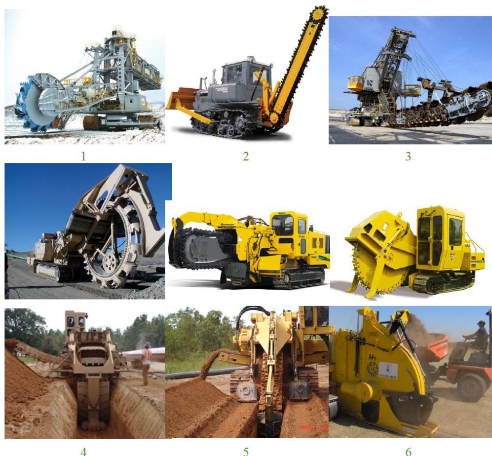
Рис. 2.12.1. Экскаваторы непрерывного действия: 1 – роторный карьерный радиального копания; 2 – цепной траншейный (бара); 3 – цепной многоковшовый поперечного копания; 4 – роторный траншейный продольного копания; 5 – цепной траншейный для широких траншей; 6 – дисковый траншейный..
