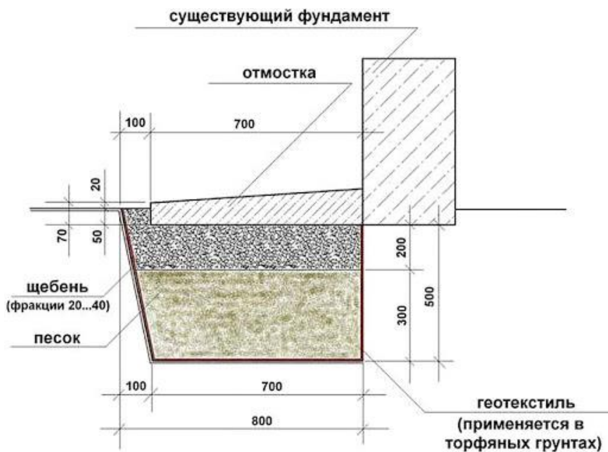
Рисунок 5.14 – Устройство отмостки.
