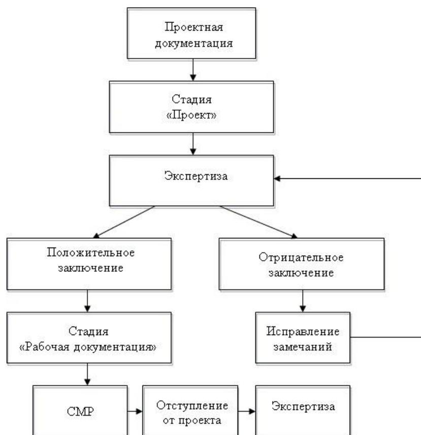
*Рисунок 2.1 – Схема экспертизы проектной документации.*
