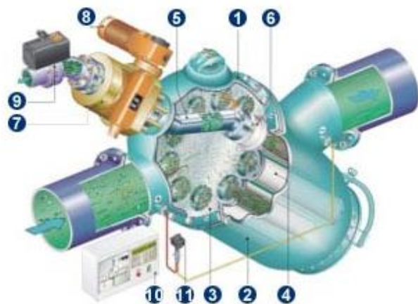
Рис. 2.21. Сетчатый фильтр PR-BW 100-FC с автоматической промывкой:
