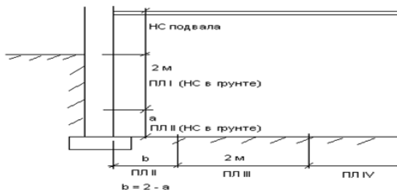
Рис.5.7. Схемы обмера ограждений при расчете трансмиссионных теплопотерь
