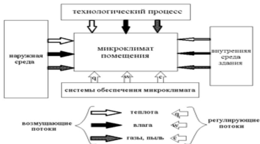
Рис.4.1. Структурная схема формирования микроклимата.
