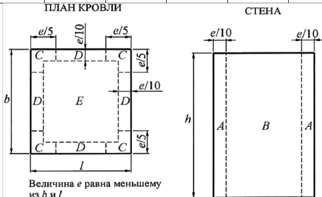
Рис. 3.9. Зоны плоских перекрытий и стен
