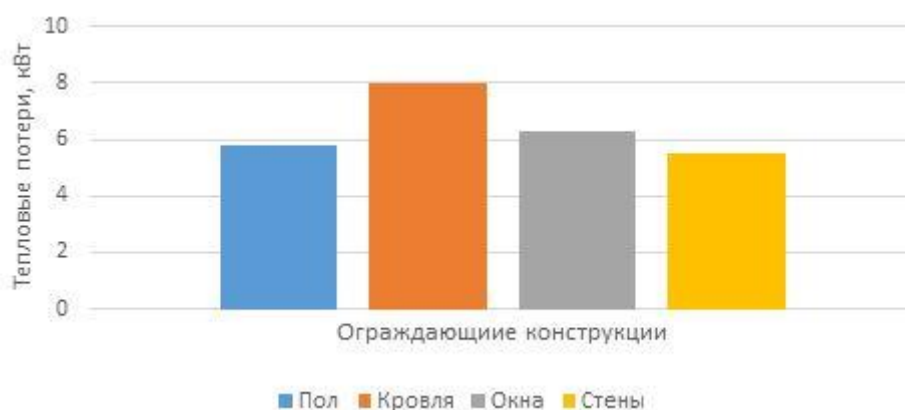
Рис.3.1. Теплотери через ограждающие конструкции
