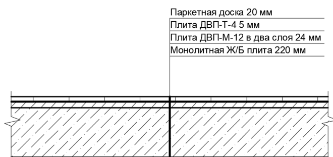
Рис. 1.2. Состав пола
