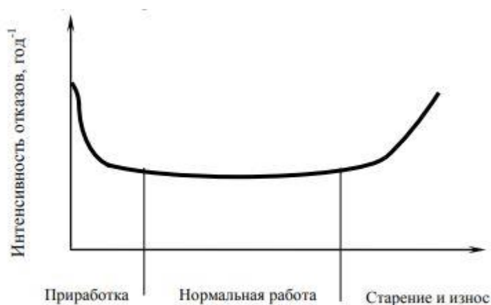
Рис. 1.4. Изменение интенсивности отказов в течение эксплуатационного периода
