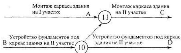
Рисунок 12 - Параллельное выполнение работ А, С и В, D с фиктивной работой 10 -11
