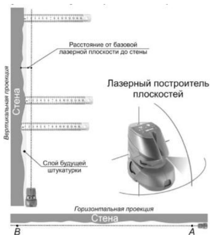
Рис. 3.2. Схема провешивания поверхностей
