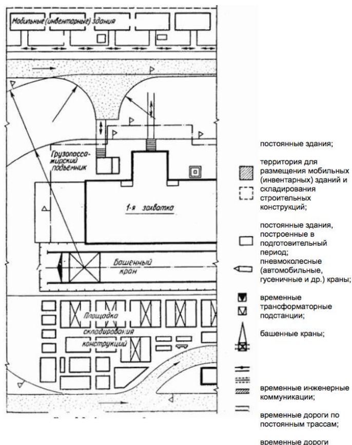
Рисунок 30. Фрагмент объектного стройгенплана
