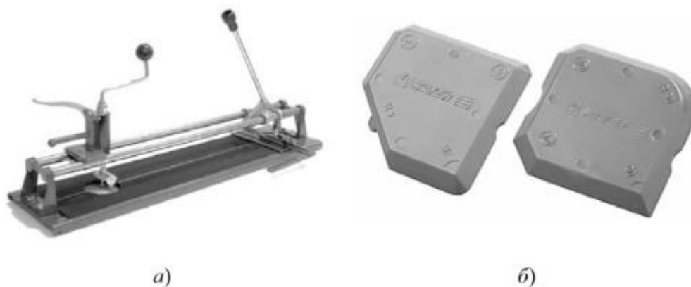
Рис. 3.23. а - ручной роликовый плиткорез с дополнительной опцией - циркулем для вырезания в плитке круглых отверстий диаметром 30...80 мм; б - специальные резиновые шпатели для формирования швов в плиточных облицовках
