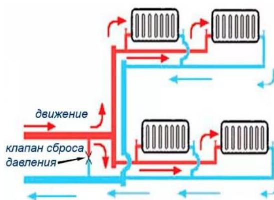
Рисунок 40 Коллекторная двухтрубная система отопления
