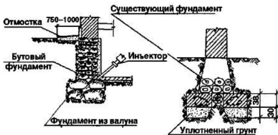
Рис. 5. Укрепление цементацией, химизацией
