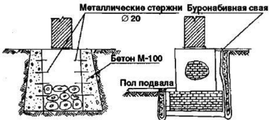
Рис. 1. Укрепление железобетонными обоймами
