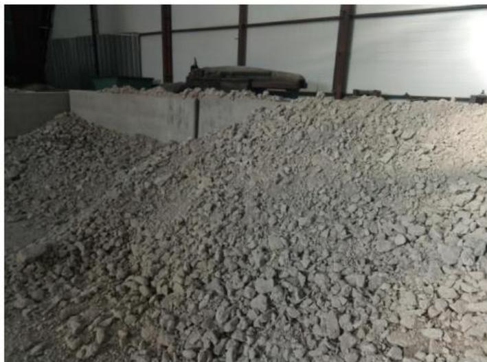
*Рисунок 5. Вторичный бетонный щебень*
