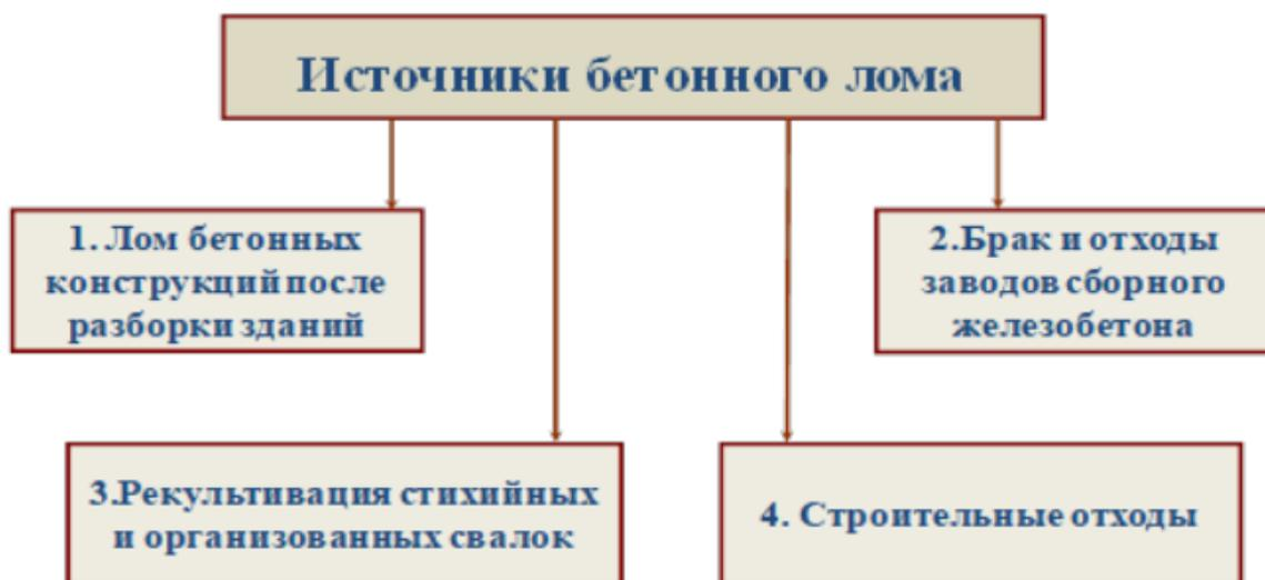
Рисунок 1. Источники бетонного лома
