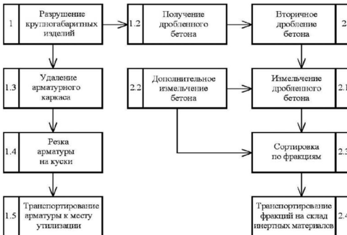
Рис. 1. Основная схема технологии переработки бетонных и железобетонных изделий.
