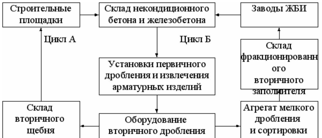
Рис. 6. Схема получения и использования щебня из отходов переработки бетонных и железобетонных конструкций
