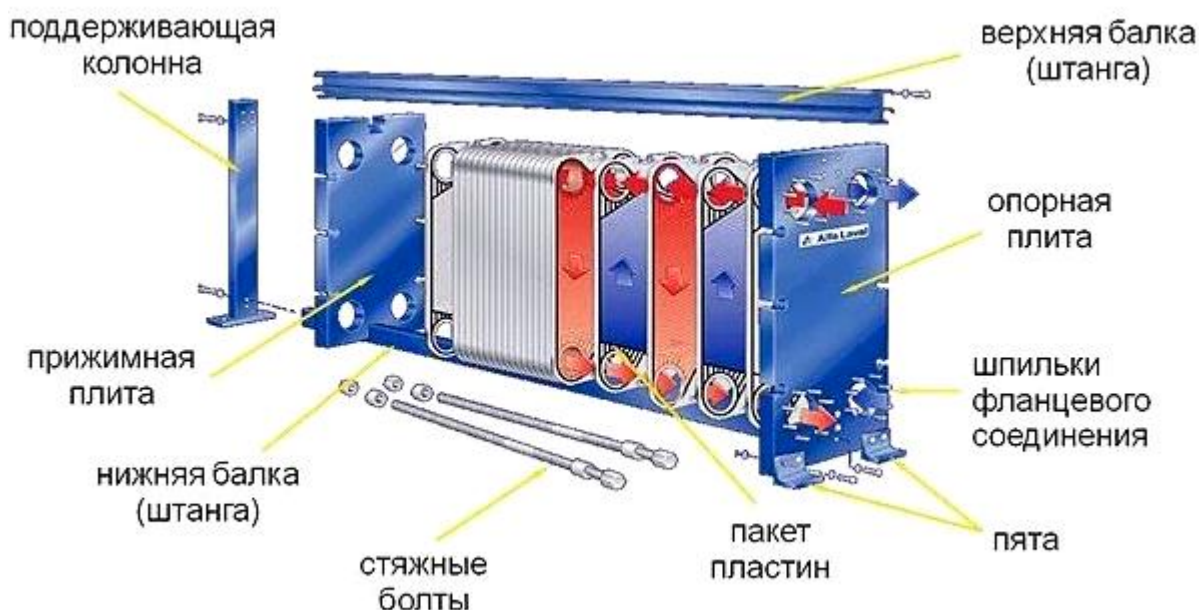
Рисунок 1.8. Пластинчатый теплообменник
