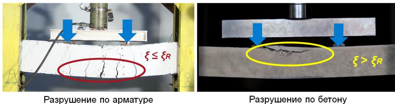
Рис. 1.16. Разрушение железобетонного изгибаемого элемента по нормальным сечениям
