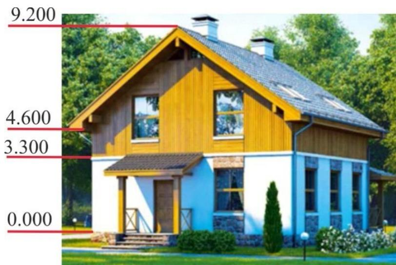
Рис.2.9 Высотные отметки здания
