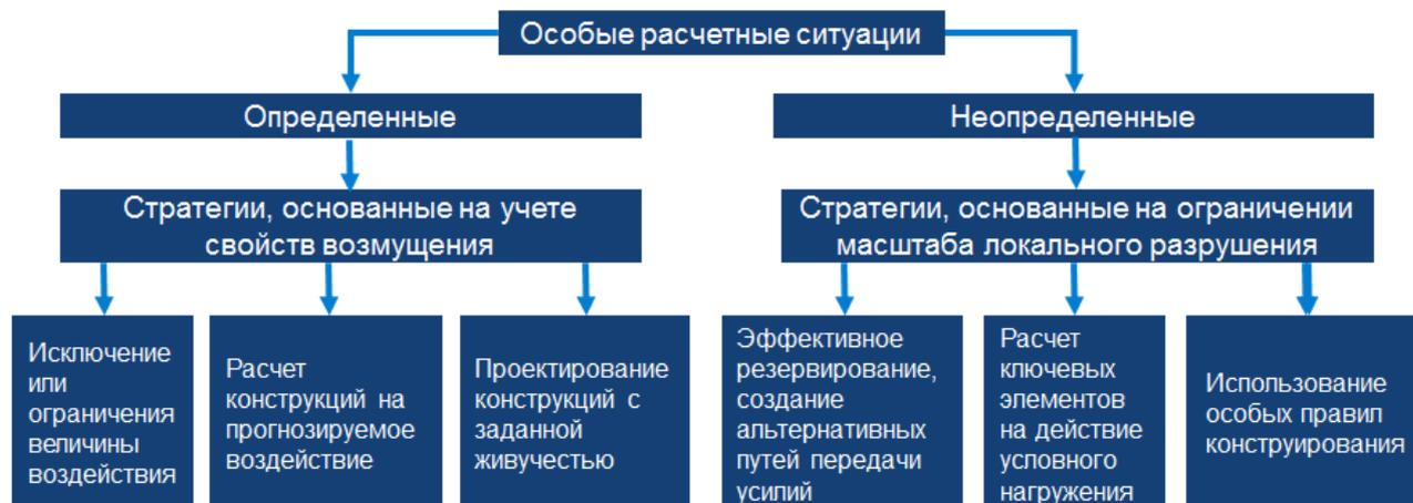
Рис. 1.22. Классификация особых расчетных ситуаций для оценки особого предельного состояния строительных конструкций
