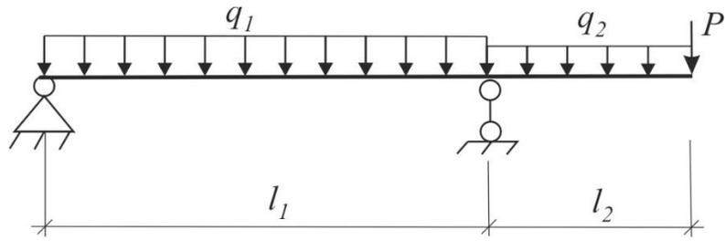
Рис. 1. Расчетная схема
