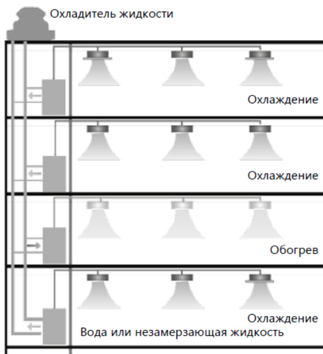
Рис. 3. Системы кондиционирования воздуха VRF с водяным охлаждением конденсатора
