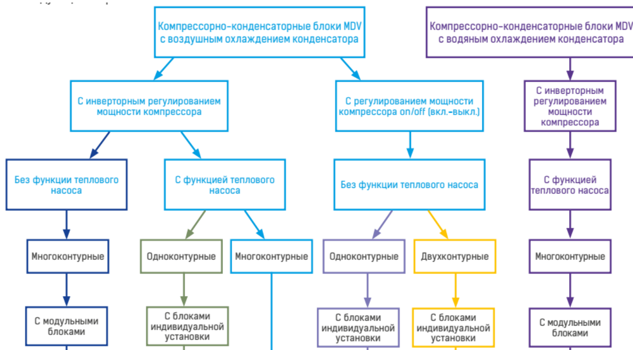
Рис.8. Классификация компрессорно-конденсаторных блоков
