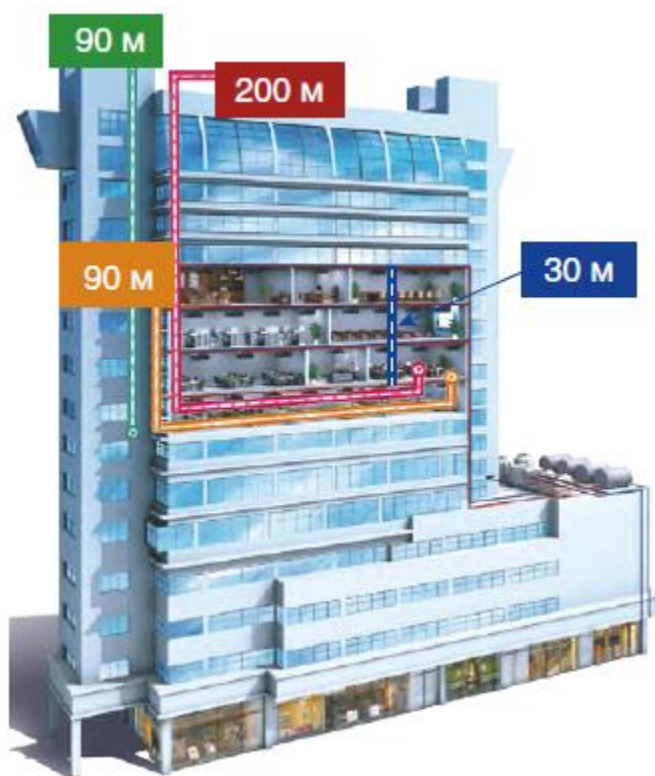
Рис. 12. Допустимые эквивалентные длины фреоновых труб для ККБ
