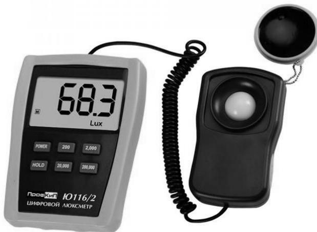
Рисунок 3. Люксметр Ю-116 для измерения освещенности.
