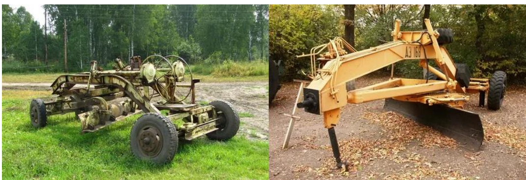
Рис. 3.20 Прицепной и полуприцепной грейдеры
