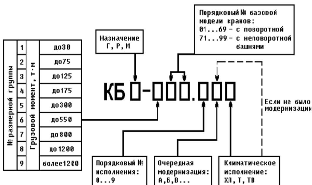
Рис. 2.38 Схема индексации башенных кранов
