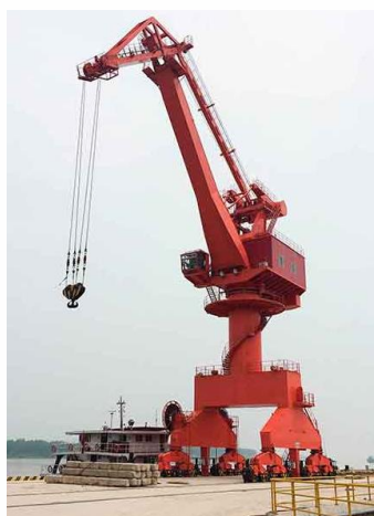
Рис. 2.33 Портальный кран с шарнирно-сочлененной стрелой
