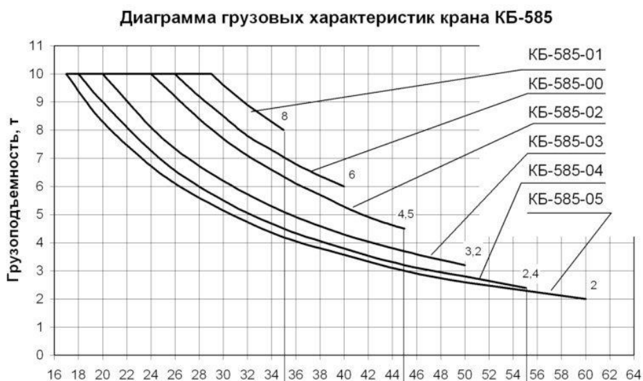
Рис. 2.39 Грузовая характеристика башенного крана КБ-585
