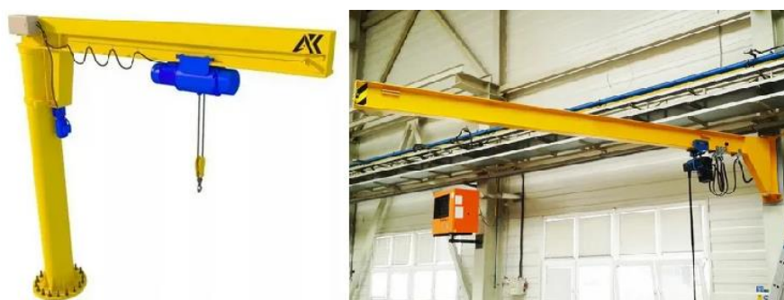
Рис. 2.25 Консольный кран на колонне и на стене
