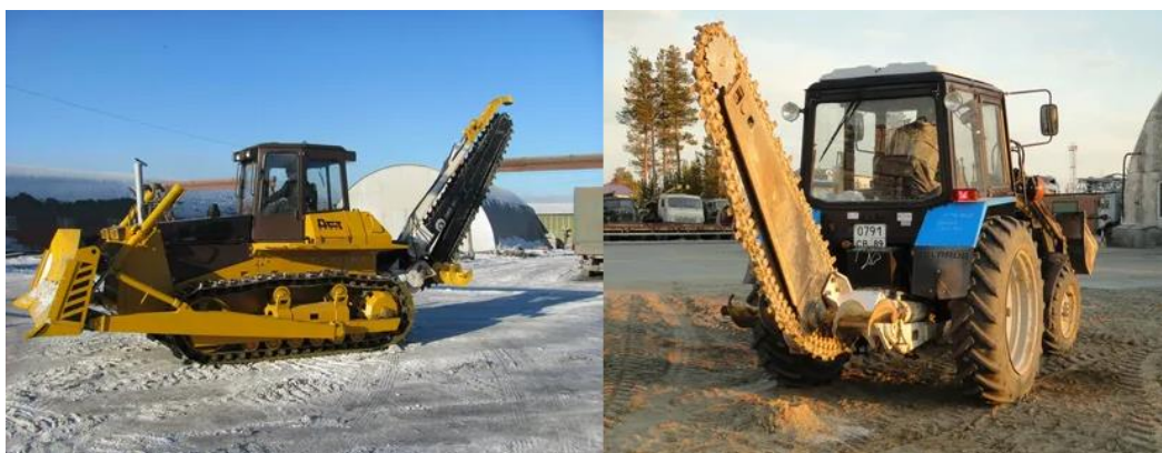
Рис. 3.14 Цепной траншейный экскаватор на гусеничном и пневмоколесном ходу
