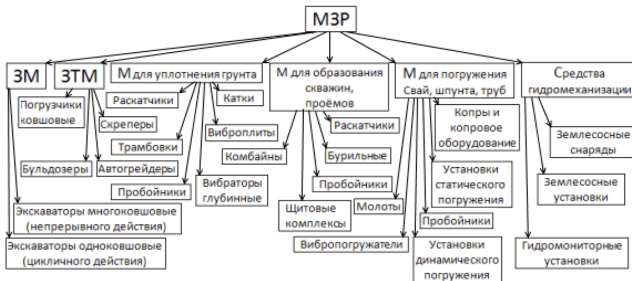
Рис. 3.1 Классификация машин для земляных работ
