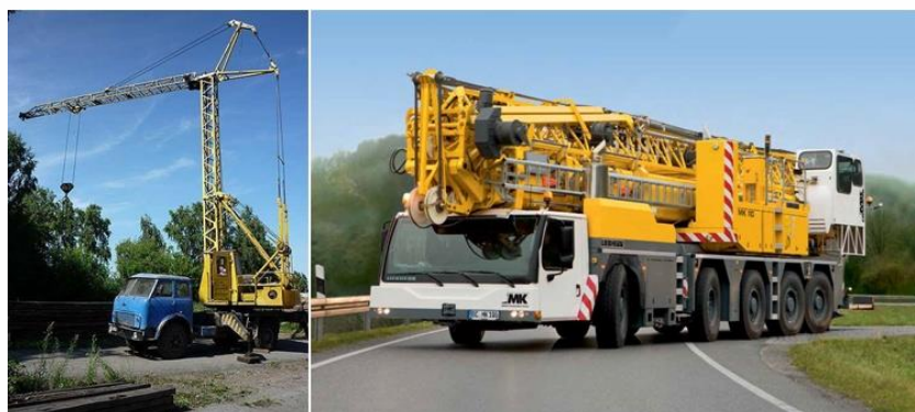
Рис. 2.36 Башенные краны автомобильный и на специальном шасси
