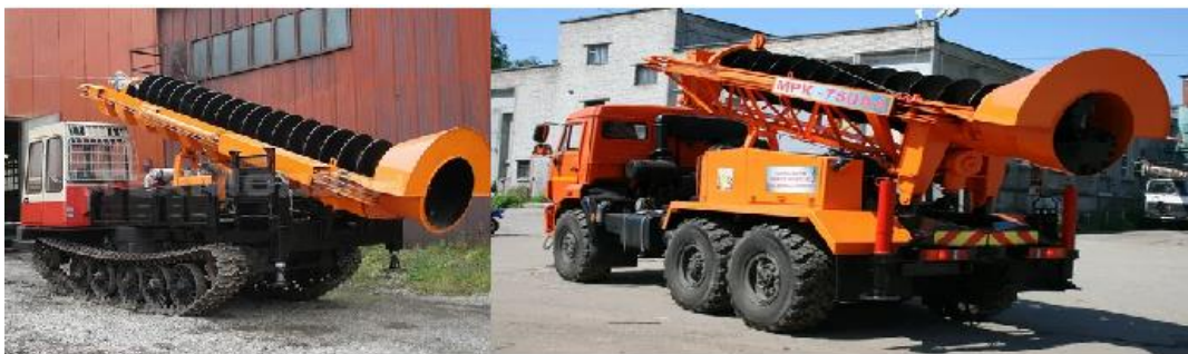
Рис. 3.22 Бурильные установки на гусеничном и пневмоколесном ходу
