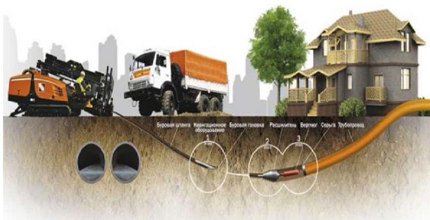
Рис. 3.31 Схема горизонтально-направленного бурения (ГНБ)
