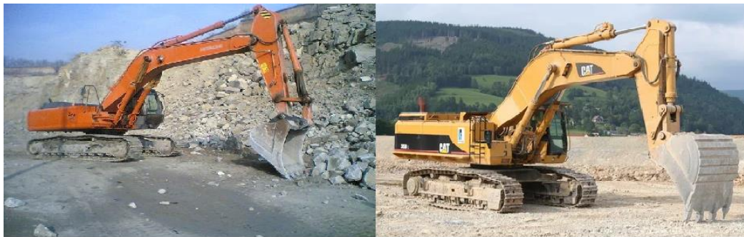
Рис. 3.10 Одноковшовые экскаваторы на гусеничном ходу с оборудованием прямая и обратная лопата
