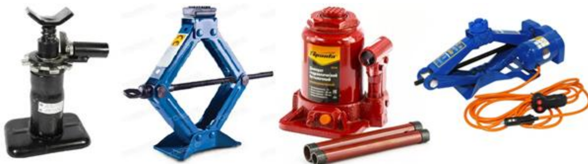
Рис. 2.16 Домкраты винтовой и ромбический, гидравлический домкрат и электрический
