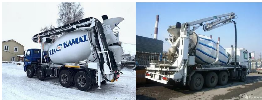
Рис. 4.6 Автобетоносмеситель с ленточным конвейером (слева) и с бетононасосом и распределительной стрелой (справа)
