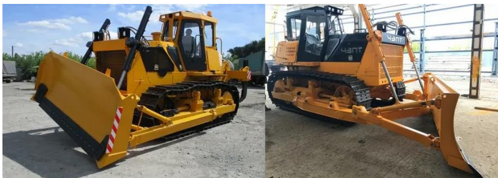
Рис. 3.17 Бульдозеры на гусеничном ходу с неповоротным и поворотным в плане отвалом
