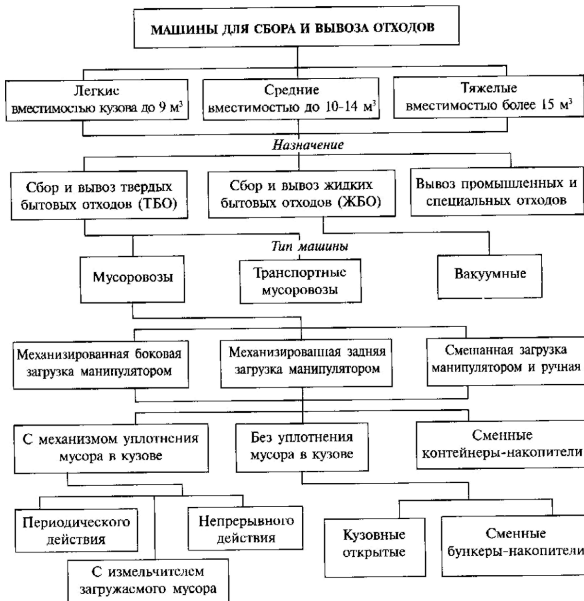
Рис. 5.1. Классификация машин для сбора и вывоза отходов
