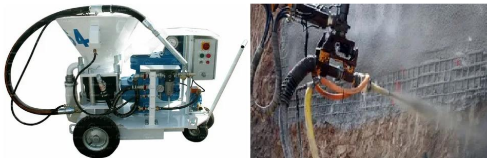
Рис. 4.8 Торкрет-установка и процесс торкретирования
