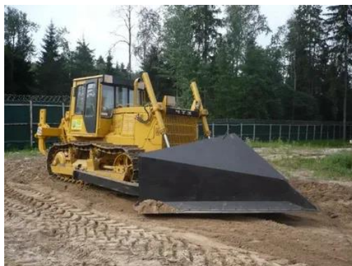
Рис. 3.5 Кусторез (навесное оборудование на гусеничном тракторе)
