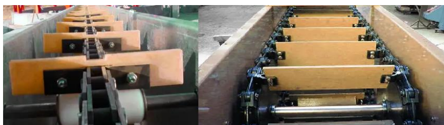
Рис. 2.45 Варианты конструкции скребкового конвейера
