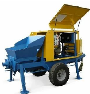
Рис. 4.7 Стационарный бетононасос и автобетононасос со стрелой-манипулятором
